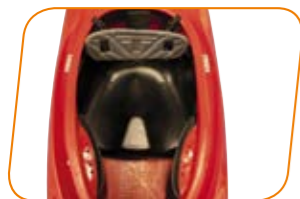
AUSFÜHRUNG „FULL FIT“ inkl. verstellbarem Sitz, MAC Oberschenkelhalter, Vario Fußstütze, Rückengurt mit Contour-Polster, Stützschaum vorne und hinten, Rodeositz 36 trimmbar
